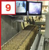
Rotopacker mit max. Stundenleistung von 3.500 Säcken sorgen für reibungslose Verpackung in 25 kg-Säcke. Anschließend werden die Säcke palettiert, foliert und zur Abholung bereitgestellt.
