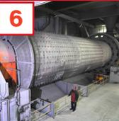
In 2 Kugelmühlen (insg. 130 t/h) wird der Zementklinker mit Gips, Hütten sand und Steinmehl vermahlen, danach gekühlt, und anschließend in die Zementsilos eingelagert.
